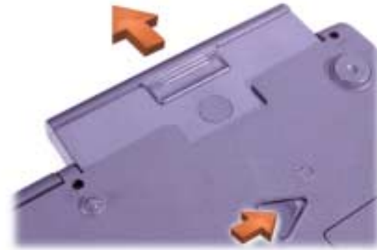
Figura 4-8. Extracción de una batería del compartimento de la batería
